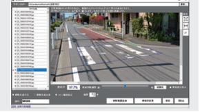
横断歩道の摩耗率を専用ソフトで解析、地図に赤、黄、青で表示します。
